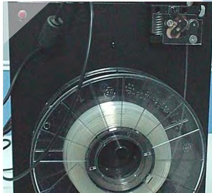
10. 打印线材完成安装
