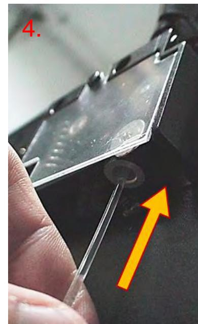
撑开进料口滑轮，并持续塞入打印线材直至无法进入为止
