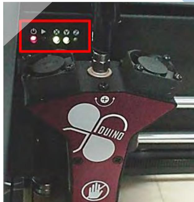
6. 待挤出头及打印平台移动至系统默认原点位置后，灯号面板X、Y灯号亮起
