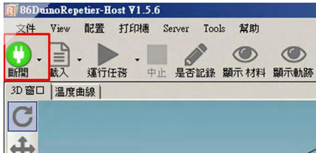
16. 此时印匠ENJOY主机播放链接成功音效，且「连接」按钮变为绿色「断开」图示，此时完成设备连接（按下绿色「断开」图标则会切断链接回到红色图示之未连结状态）。
