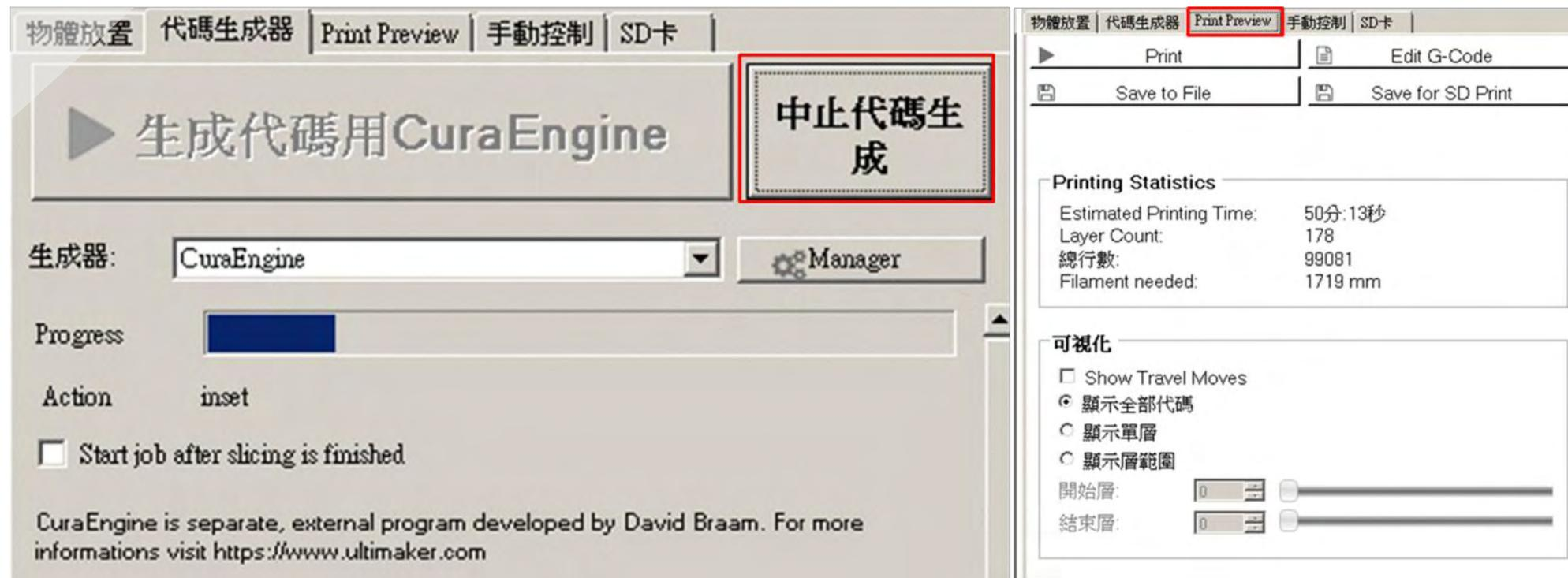
6. 此时显示打印代码产生进度，若要取消代码产生可点击「中止代码生成」按钮
