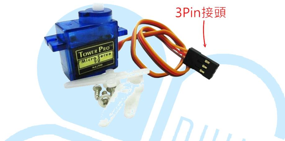
図 5. 一般的な SERVO で使われるコネクタ
