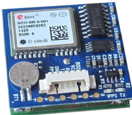
図 1. TTL 信号輸出の GPS モジュール
