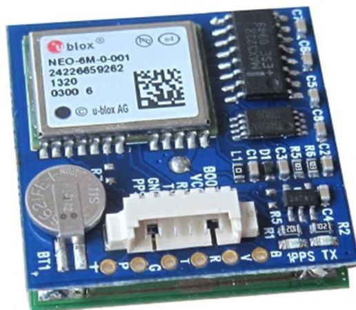
图 1. TTL 讯号输出的 GPS 模块
